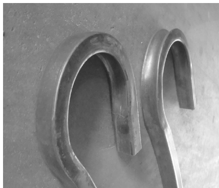
图 3-73 矩形管加灌黄沙前后的弯曲效果对比
