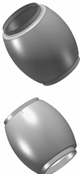
图 9-1 罗汉杯胀形后阳角辗压前后的外观
