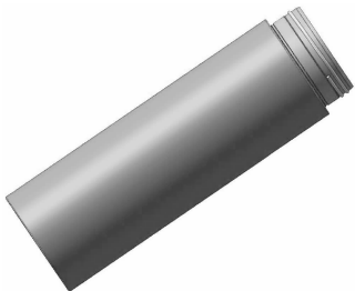
图 9-9 螺纹起点与终点错开
