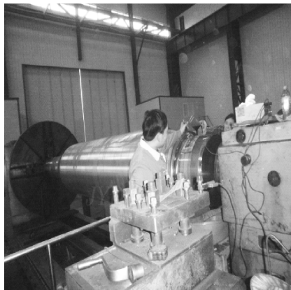
图 11-1 采用电刷镀技术修复机械磨损的 JK100 轴类产品
