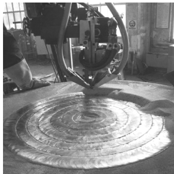
图 9-20 埋弧堆焊在大型水轮发电机主部件转轮室上的应用
