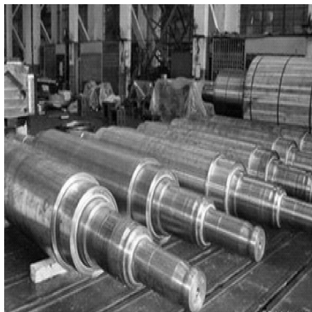
图9-1 采用堆焊方法 修补后的旧轧辊
