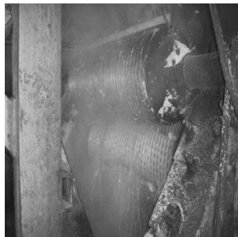
图 9-24 \text{CO}_2 气体保护自动堆焊进行修复的榨辊轴
