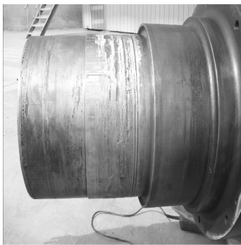
图 1-3 机械加工后表面受到损伤的轴
