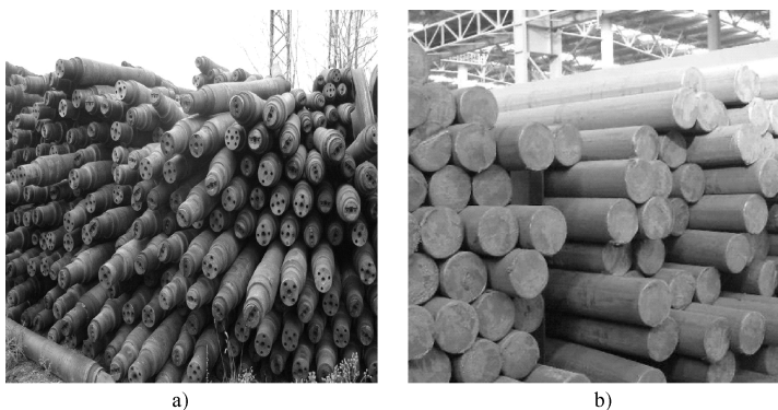
图 11-4 轴类再制造的毛坯和轴类制造的毛坯
