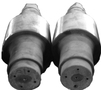
图 9-3 利用堆焊技术修复的冷轧辊
