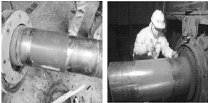
图 1-6 表面受损的轴进行再制造刷镀
