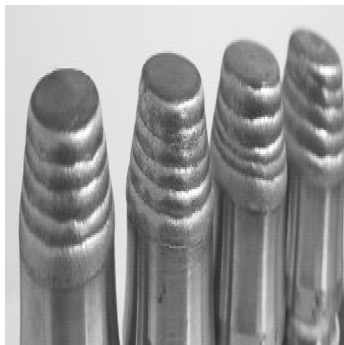
图 9-29 等离子弧自动堆焊和钎焊的硬质合金刀头
