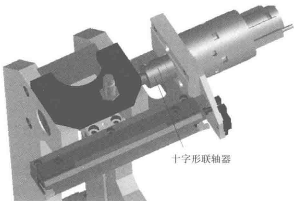
图 4-37 旋转气缸常用十字形联轴器
