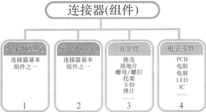
图 3-7 连接器的组件构成
