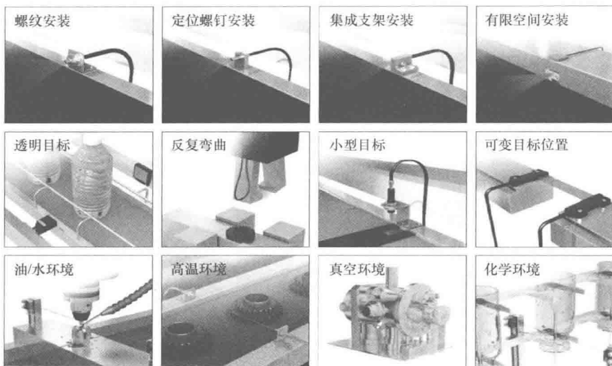
图 3-143 光纤传感器的应用案例
