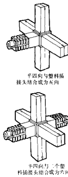
金属插接头与塑料插接头连接方法
